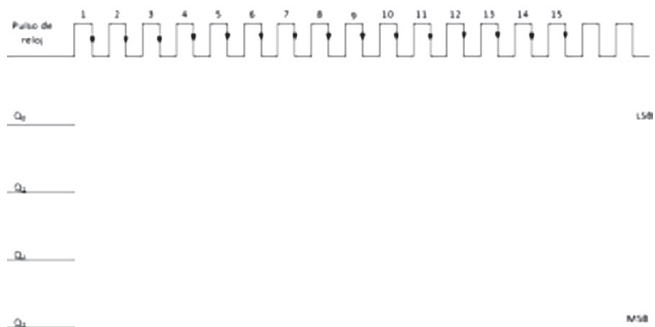
Figura 71 Diagrama del tiempo de contador síncrono de 4 bits descendiente
